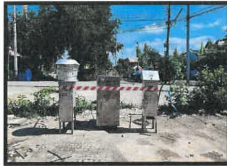
ภาพที่ 4.4.1-1 (ต่อ) การเก็บตัวอย่างฝุ่นละอองในบรรยากาศโดยทั่วไป
