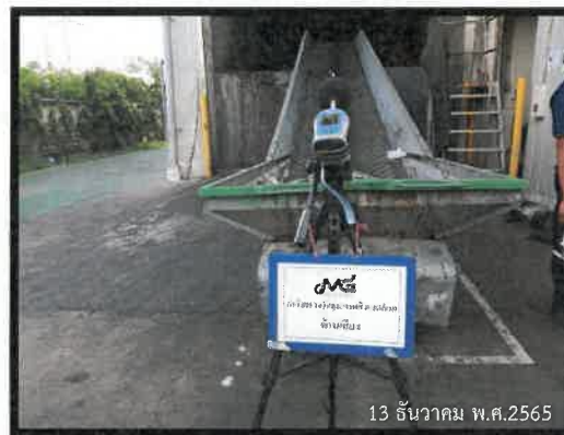
ภาพที่ 4.2.3-1 การตรวจวัดระดับเสียงเฉลี่ยตลอดระยะเวลาการทำงาน TWA 8 hrs
