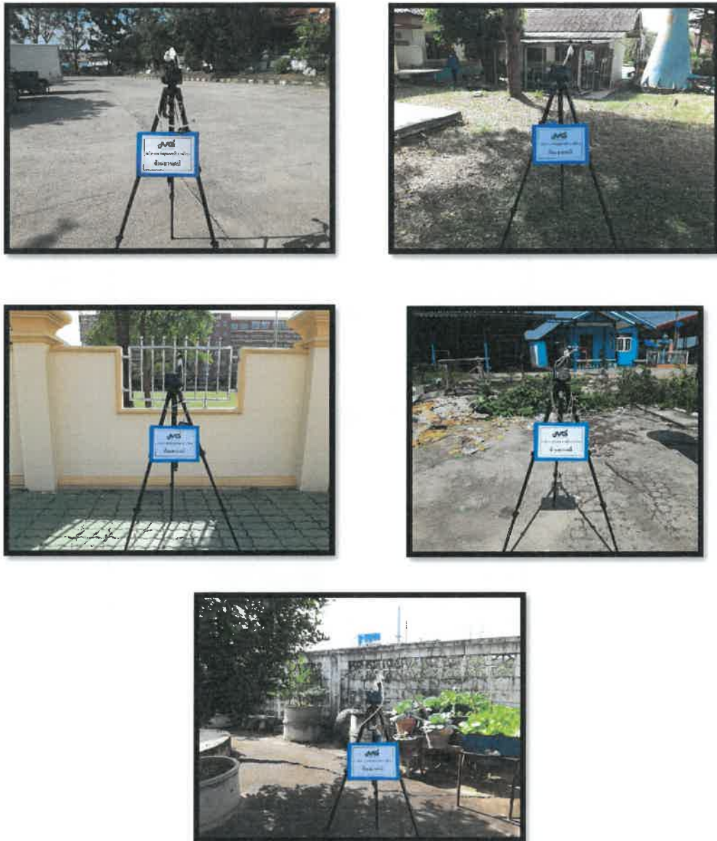
ภาพที่ 4.4.2-3 คุณภาพอากาศในบรรยากาศไฮโดรเจนคลอไรด์ (HCL) และตะกั่ว Lead (Pb)
