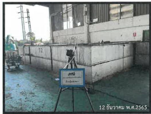
ภาพที่ 4.2.5-1 การเก็บตัวอย่างการตรวจวัดฝุ่นละอองทุกขนาด (Total Dust)
